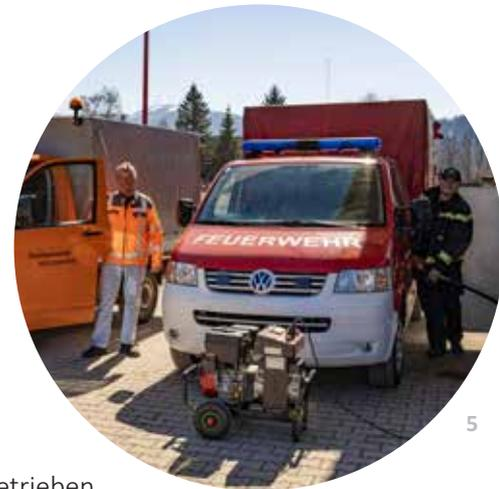
Betrieben wird dieser Tank mit einem mobilen Notstromaggregat. Zur Versorgung von 1-2 Trafobezirken max. 450 kVA haben die Stadtwerke eine mobile Stromversorgung in Form eines LKW Anhängers zur Verfügung.
